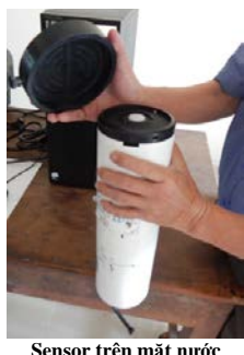
c. Hệ thống máy đo độ rọi sáng dưới nước PRR-2600
