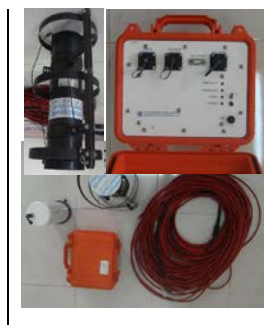
c. Hệ thống máy đo độ rọi sáng dưới nước PRR-2600
