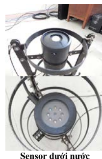
c. Hệ thống máy đo độ rọi sáng dưới nước PRR-2600
